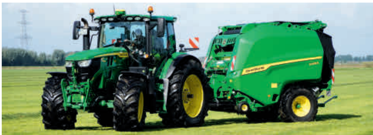
↑ Modele V452R i V462R mają hydraulicznie regulowany dyszel, który za pomocą tłoka zmienia położenie prasy nad pokosem i może się ruszać do 38 stopni na boki
